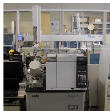
LECO 社 ガスクロマトグラフィー 飛行時間型質量分析装置 「Pegasus HT」
